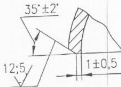
Примечание - Для отводов  $D_n = 57$  мм допускается торцовка без разделки кромок.
